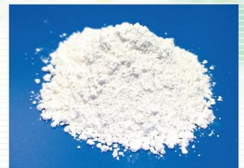
酸性ガス除去用高反応消石灰
